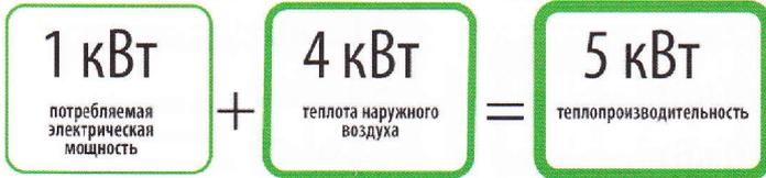
Затрачивая 1 кВт электрической мощности на привод компрессора, тепловой насос вырабатывает до 5 кВт тепла
